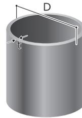
ニュータイカライト R による耐火被覆工法では、被覆対象鋼材サイズの、鋼材径 (D) と鋼材厚み (t) の関係 (径厚比) に制限があります。被覆タイプに応じて、それぞれ下表に示す径厚比表をご確認願います。
