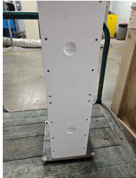
写真6 耐衝撃試験後試験体
