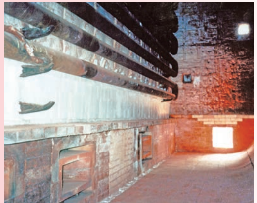
加熱炉内部無機繊維系保温断熱材ブロックライニング
