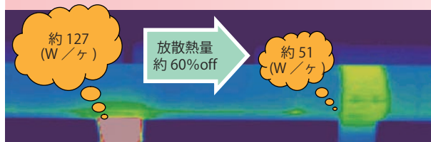
サーモグラフィー画像 (左：一般の配管支持 右：サーモカットリング)
