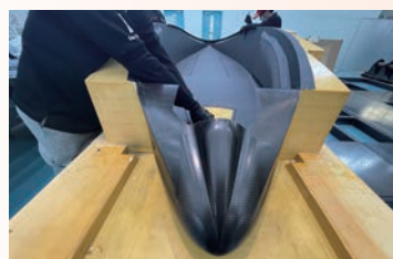
アルティーボードFSを型材に使用しCFRPを製作中
